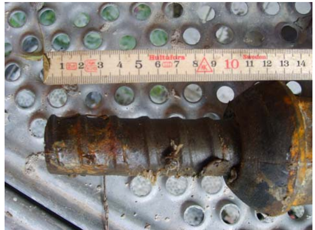
Abgebrochener Teil des Ankers Nr. 44 mit Mutter.
