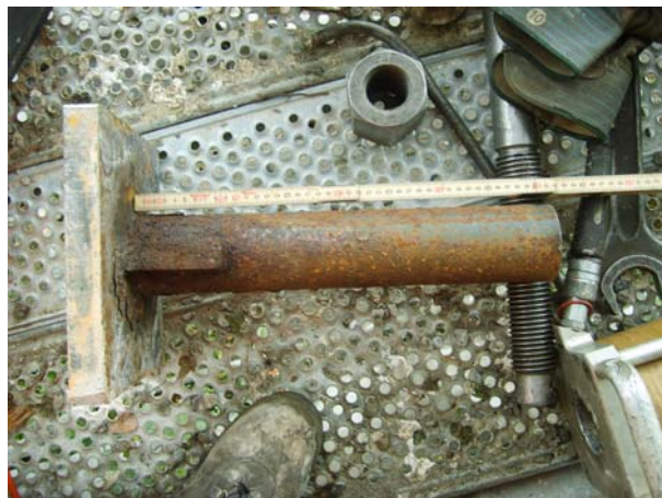
Bild 14 K2b LU, Verankerter Stützkörper Riedsort
