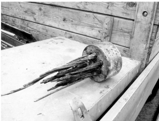
Bild 5: Bruch eines 1979 eingebauten Litzenankers
