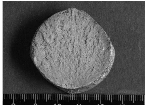
Bild 4: Sprödebruch eines 1977 eingebauten Stabankers
